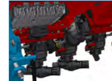
Abonador FertiSmart Con transmisión ISM (Integrated Smart Motors) Un motor para varias dosificaciones
