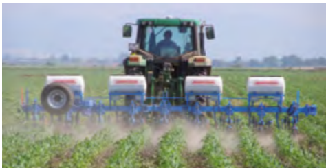
Binadora rígida TIP 5 pulgadas 8 hileras con distancia entre hileras de 70 cm durante el trabajo
