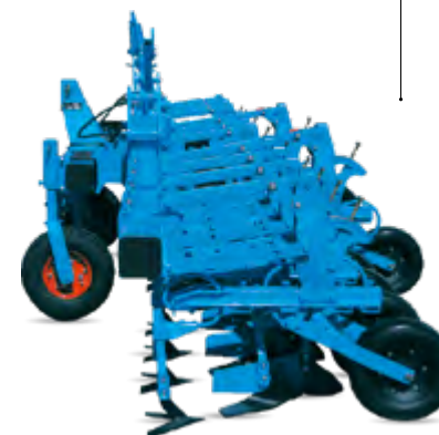
Binadora frontal «unidades invertidas» 12 hileras con una separación entre hileras de 45cm
