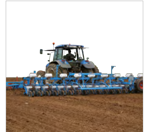
Sembradora MECA V4 rígida triple-barra 18 filas con Microsem y carro de transporte
