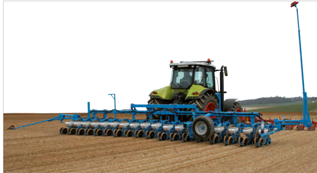
Sembradora MECA V4 rígida triple-barra 18 filas con carro de transporte
