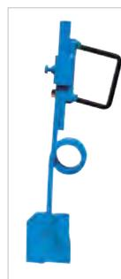
El abono se coloca en el suelo mediante enterradores de reja. Estos enterradores incorporan un dispositivo de seguridad accionado por resorte y regulable en altura.
