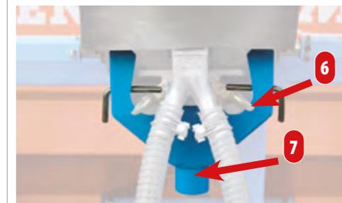
La capacidad de la tolva en los sistemas Microsem es de 20 L. Las trampillas (6) y la canaleta (7) permiten un vaciado sencillo y rápido del producto restante.
