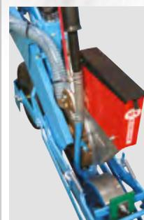
La salida del Microsem El insecticida (5) se coloca justo detrás de la reja para su aplicación en la línea de siembra.
