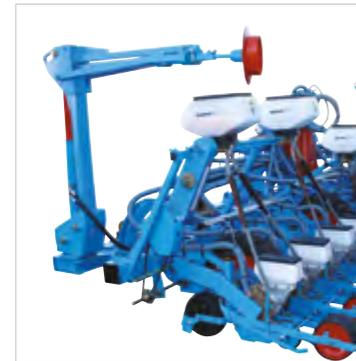
Trazador hidráulico de disco abatible para chasis plegable (distintos modelos en función del chasis).
