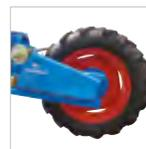
Bloque regulable con rueda 500 x 15 y caja distanciadora integrada
