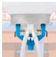
La tolva en los sistemas Microsem tiene una capacidad de 20L. También se ofrecen tolvas de 40L opcionalmente (montaje según chasis). Las trampillas y la canaleta permiten un vaciado sencillo y rápido del producto restante.
